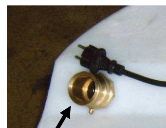
ORIFICE SORTIE, PRISE RAPIDE MÂLE LOK 1 ½”
